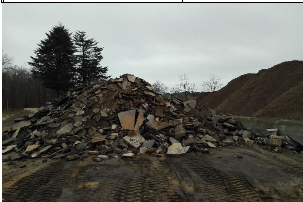
Oplag af ikke knust asfalt.
