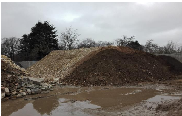
Oplag af knust tegl, fliser og murbrokker.
