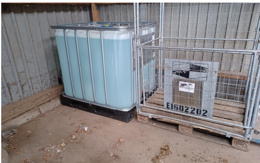
Figur 10. Pallettank med AdBlue i garagen.
