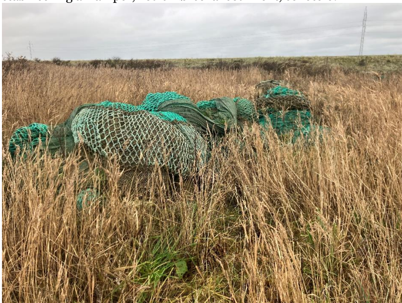
Foto 6. Gamle fiskegarn til brug for stabilisering af køreveje til aflæsning af sediment.
