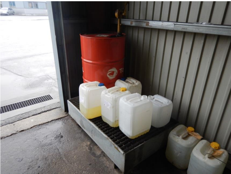
16. Opbevaring af olie til opvarmning af silo-spidseser og rester af asfaltrens.
