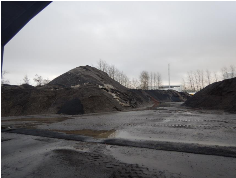
7. Oplag af genbrugsasfalt til nedknusning.
