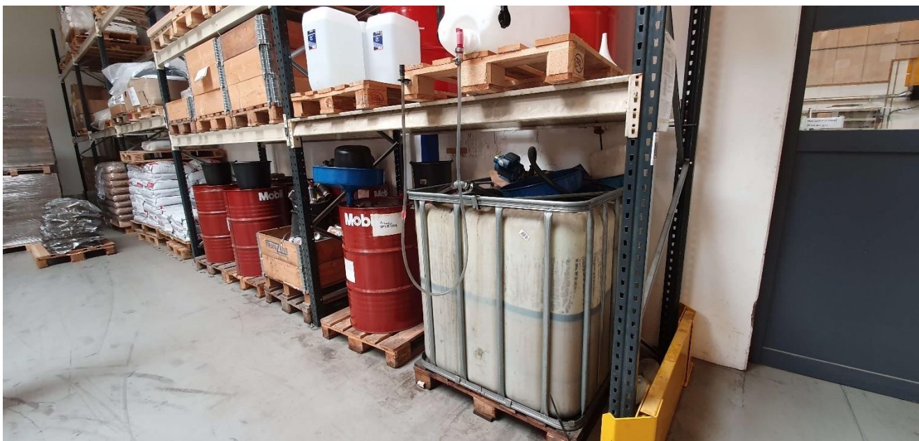
Spildolie opbevares i tromle og palletank.
