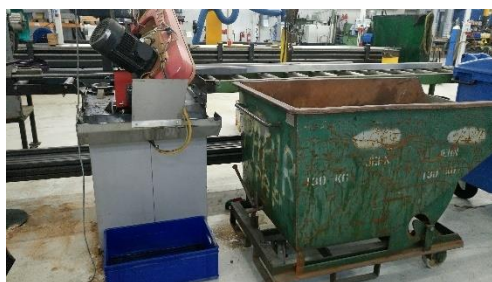
Billede nr. 6: Opbevaring af metalspåner Bakke til opsamling af evt. spild under sav
