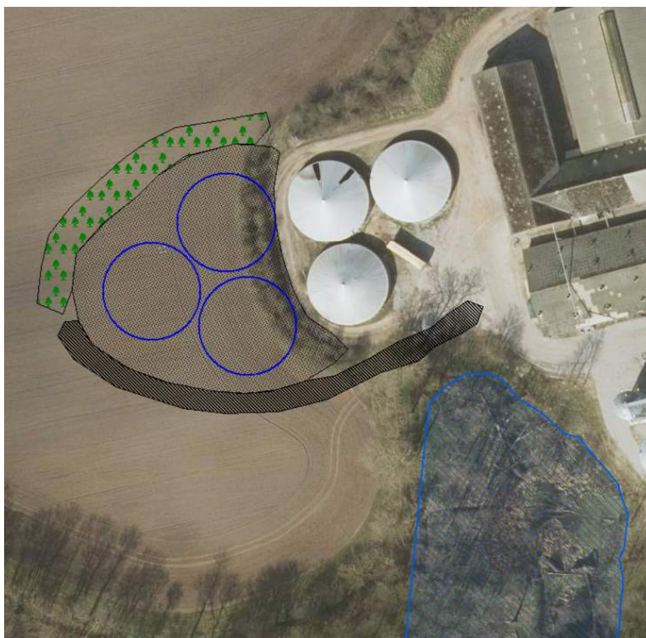
Figur 1 Beholderne som vi ønsker dem placeret. Skravering er beholderbarrierer mod søen, det prikkede areal er køreveje og det grønne er læbælte.
