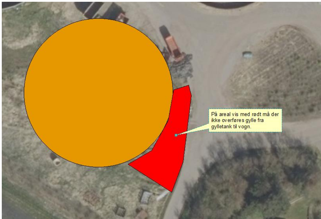
Figur 4. På areal vist med rødt må der ikke overføres gylle fra gylletank til vogn.
