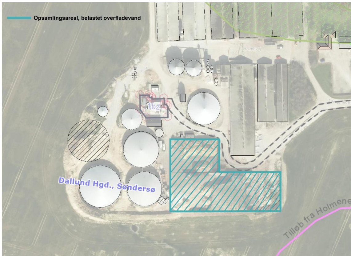
Figur 4 Oversigt over anlæggets opsamlingsareal for belastet overfladevand.
