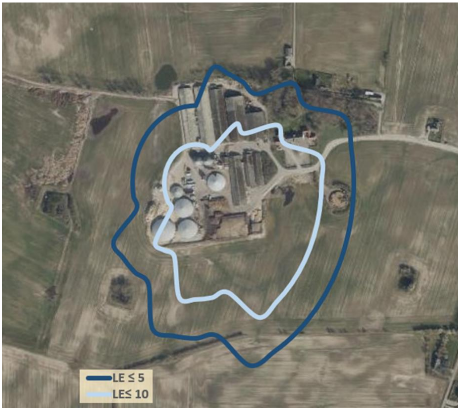
Figur 1 - Grafisk afbildning af hvorledes lugt fra anlæggets ovennævnte kilder breder sig. Udgangspunktet er lugtcentrum, som er afkastet fra modtagetanken, biogasanlæggets største afkast.
