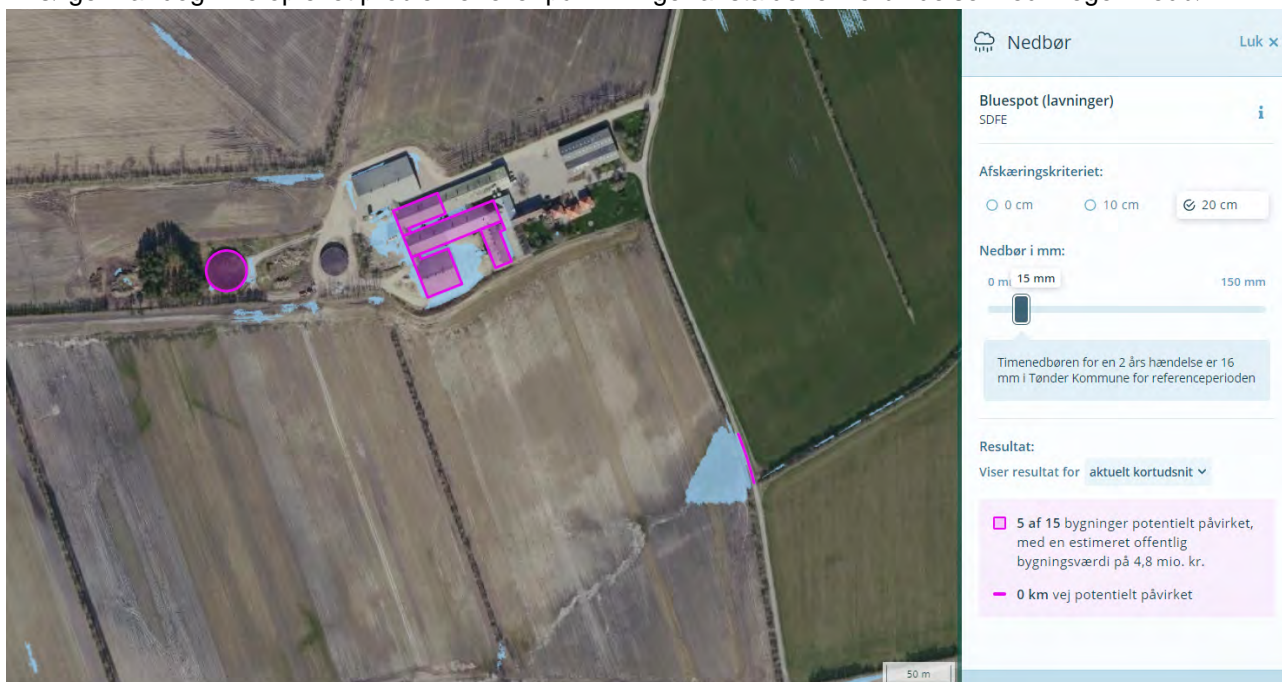
Figur 11: Lavninger omkring husdyrbruget, der kan påvirkes ved større nedbørsmængder. Kilde: kamp.miljoportal.dk
