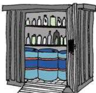
Figur 2 Udendørs opbevaring i container med dobbelt bund.
