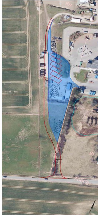
Figur 6 Afvandingsforhold for det nye omlasteanlæg. Områderne tegnet med rødt illustrerer adgangsvej og tagarealer, og den blå polygon illustrerer øvrige befæstede arealer.
