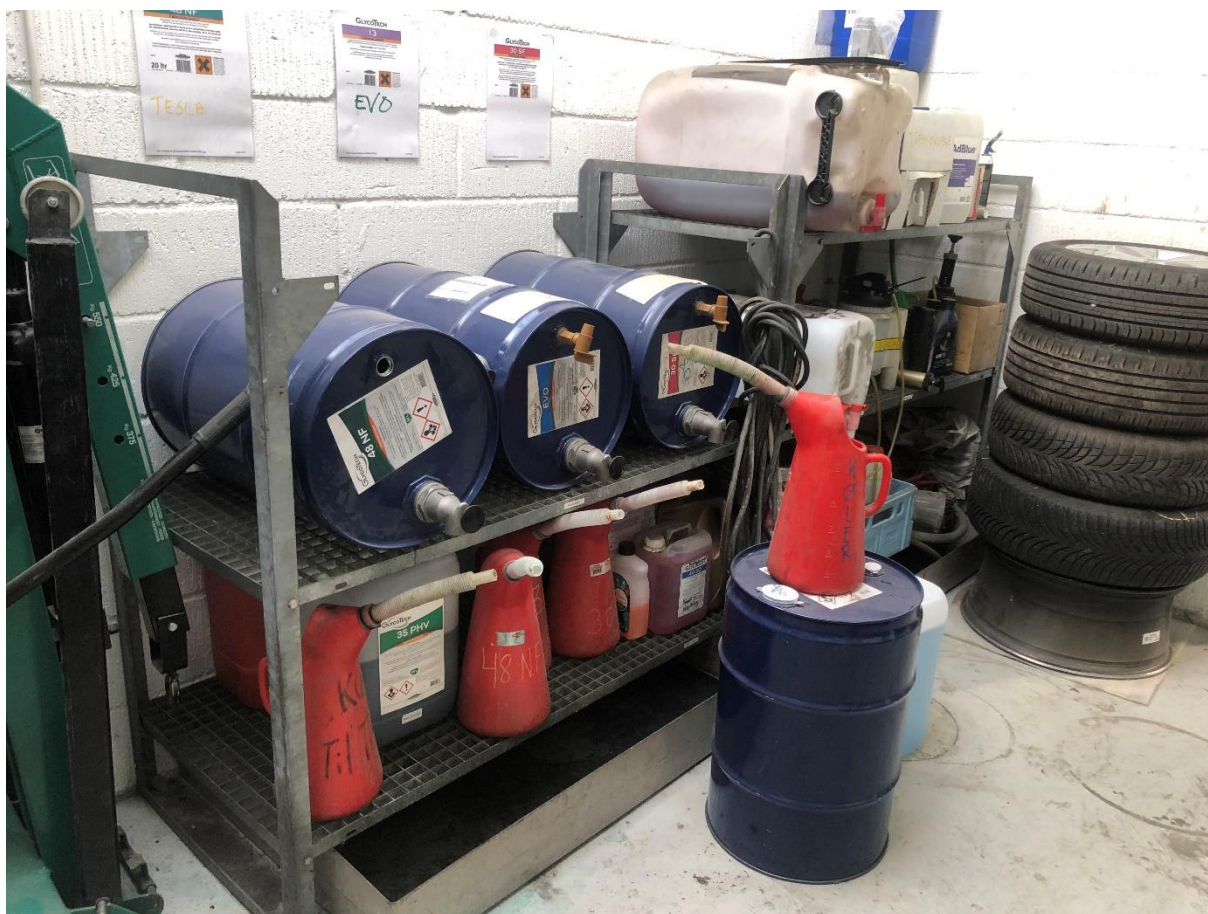
Billede 1. Oplag af kemikalier på riste som er placeret ovenpå spildbakke.
