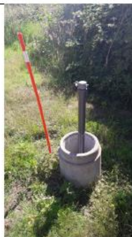
C5 - med vandtæt lukning og lås på det høje rør og lav beskyttelsesbrønd.
