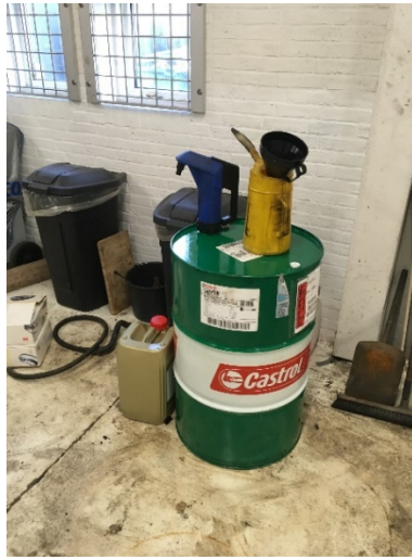
Oplag af motorolie uden spildsikring og tæt på port med mulighed for spild til omgivelserne.
