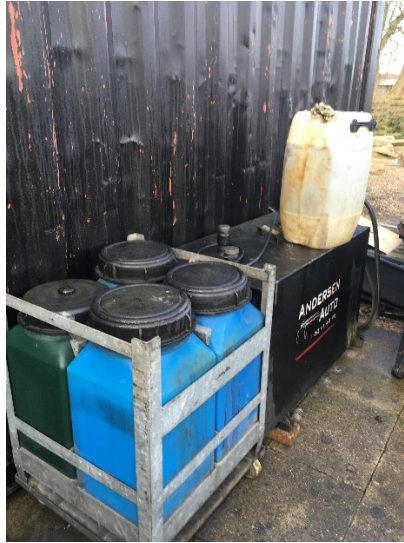
Oplag af farligt affald i IBC Multicontainer samt beholdere til spildolie, udendørs og uden spildsikring.
