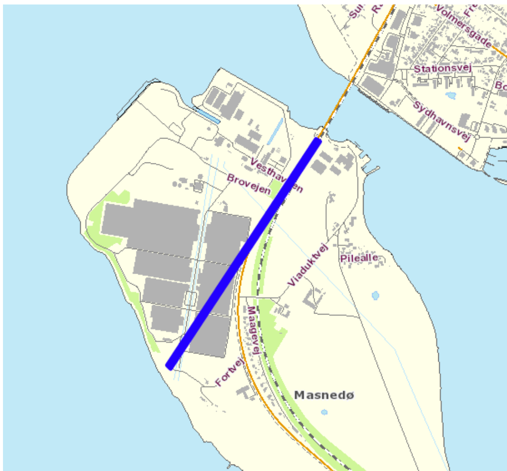
Figur 1. Vej- og broprojekt på Masnedø. Den blå linje angiver placeringen af den nye vejdæmning, hvortil der kan anvendes affaldsforbrændingsslagger.
