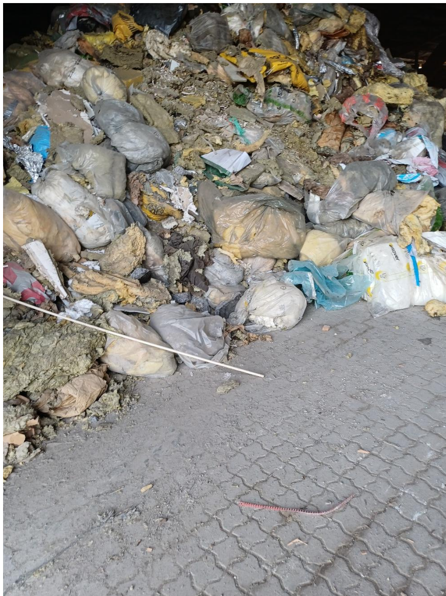
Isolering fra genbrugsplads (er farligt affald, hvis isoleringen er produceret inden 1997)
