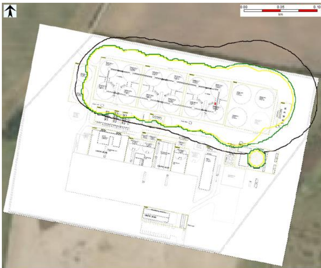
Figur 2: Udklip fra sikkerhedsdokumentet. Oversigtskort med angivelse af ISO-kurver. Rød = 1 \cdot 10^{-6} , Gul = 1 \cdot 10^{-7} , Grøn = 1 \cdot 10^{-8} og Sort = 1 \cdot 10^{-9} (maksimal konsekvensafstand).
