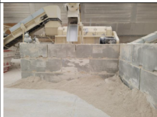
4. - 7.Grinder og færdigt gipspulver
