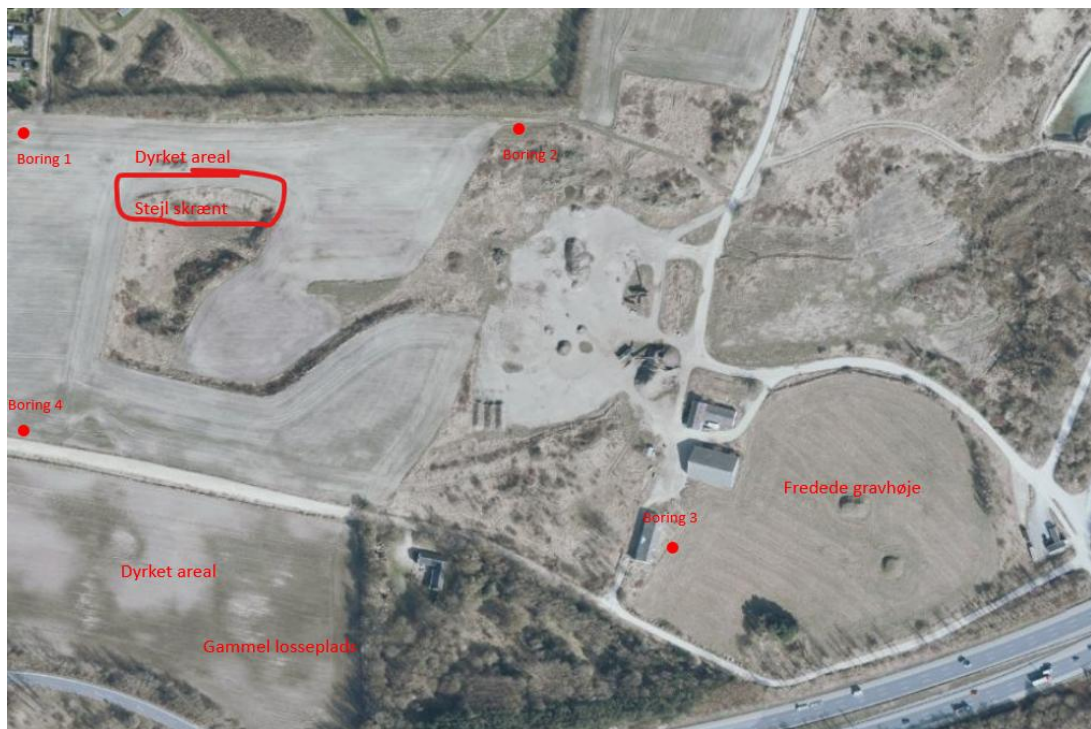
Figur 2: Kallerup Grusgrav deponi med monitoringsboringer og omgivelser
