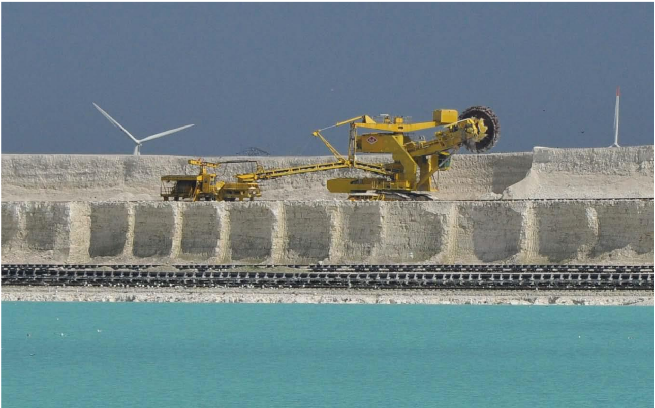
Figur 1. Skovlhjulsmaskine, der udgraver kridt over vandspejl.
