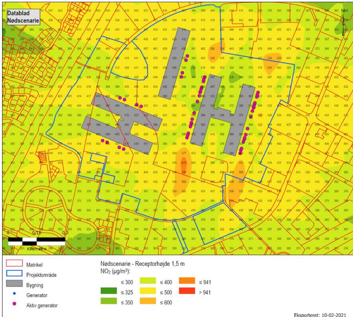
Figur 10 Koncentration af \text{NO}_2 i omgivelserne i receptorhøjde 1,5 m over terræn når 45 generatorer er i drift ved individuelle belastninger. Immissionskoncentrationer over den sundhedsbaserede AEGL 1 værdi på 941 \mu\text{g}/\text{m}^3 optræder ikke. Skorstenshøjde er 18,1 m for bygning 1, 2, 5 og 6 og 20 m for bygning 3.
