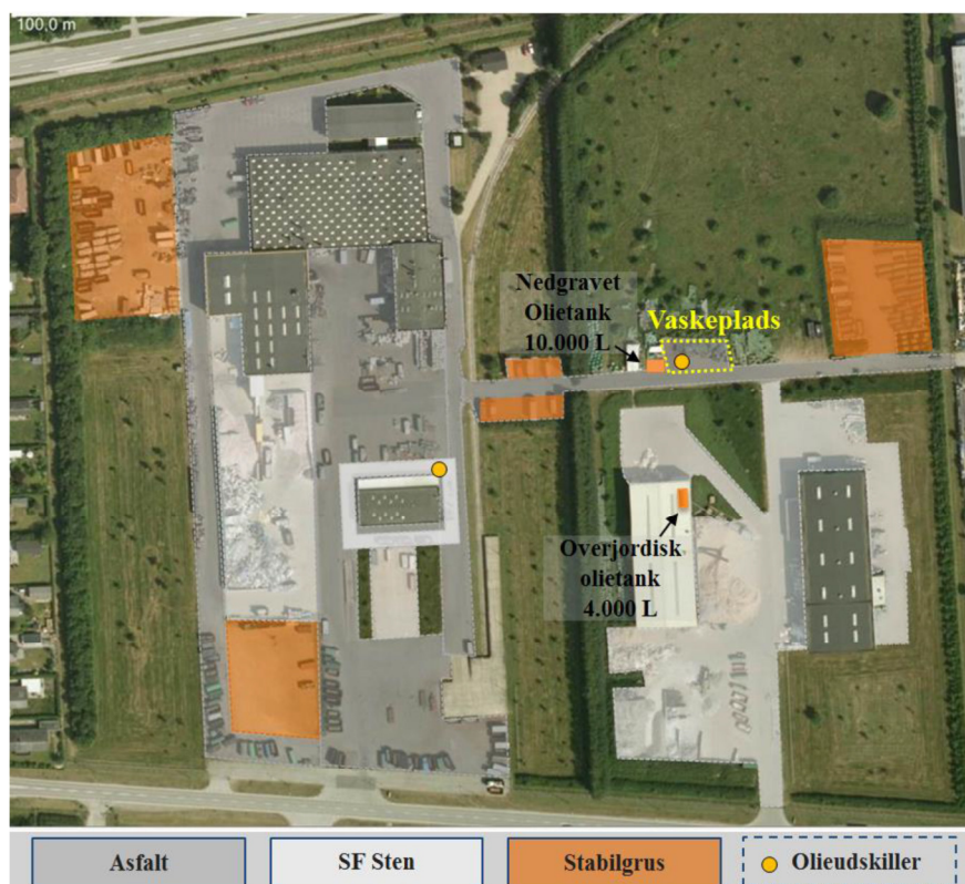
Figur 2. Belægningsforhold og placering af vaskeplads og olietanke
