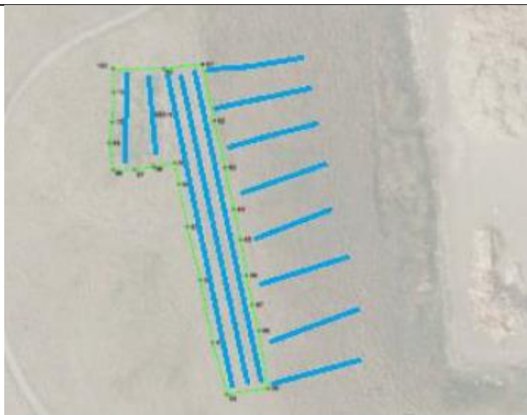
Fig. 2.9 Placering af biocover og dræn, Biocover Vest 2. (fra dokumentationsrapport dat. 5. nov. 2019). Biocover skulle være gravet ned til kontakt med affaldet. Er det dokumenteret ved inspektion?
