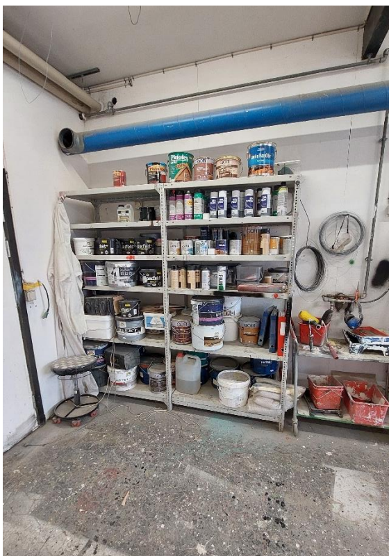
Billeder fra opbevaring af maling og kemikalier på åbne hylder i værkstedslokaler og uden spildbakke.
