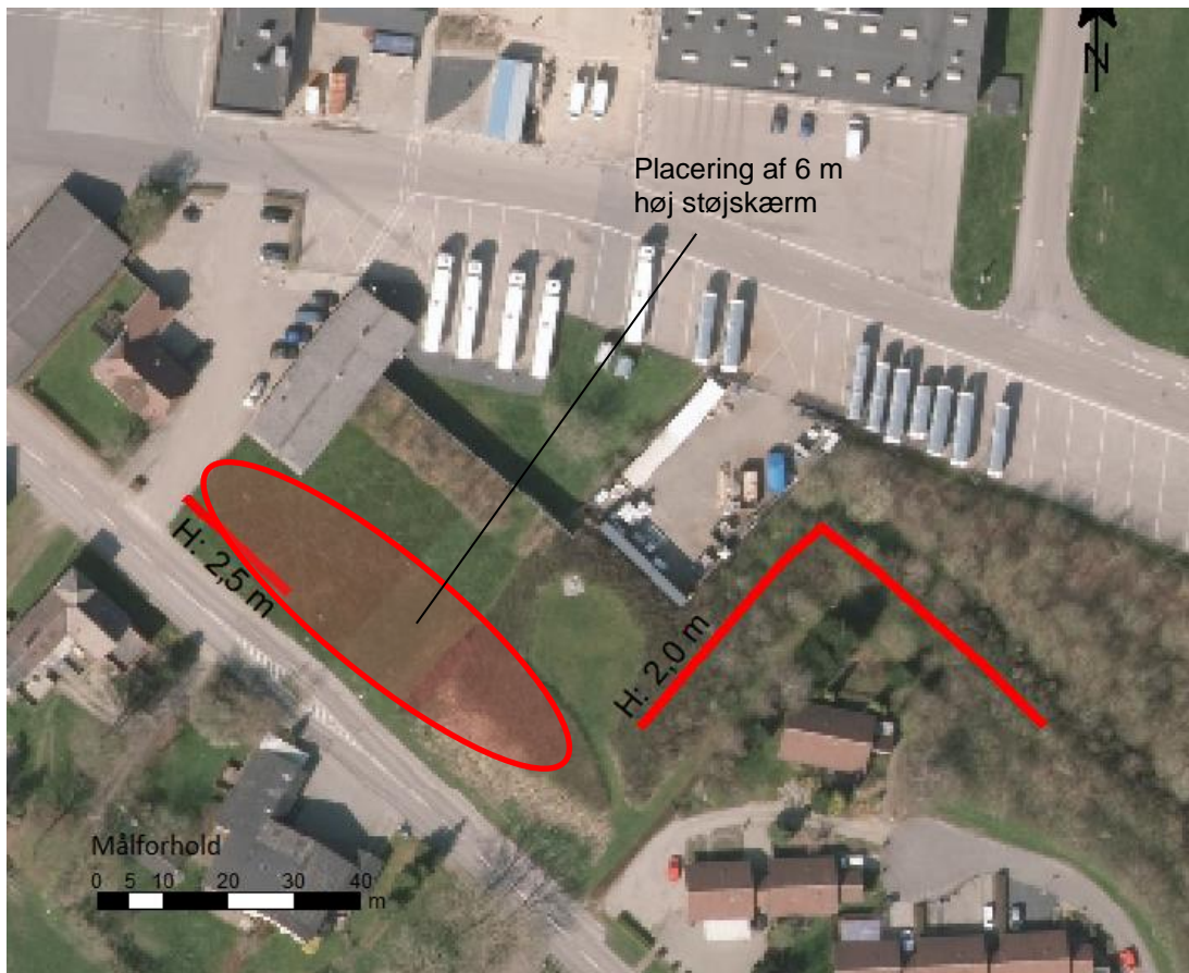
Figur 2: Placering af nye støjskærme.
