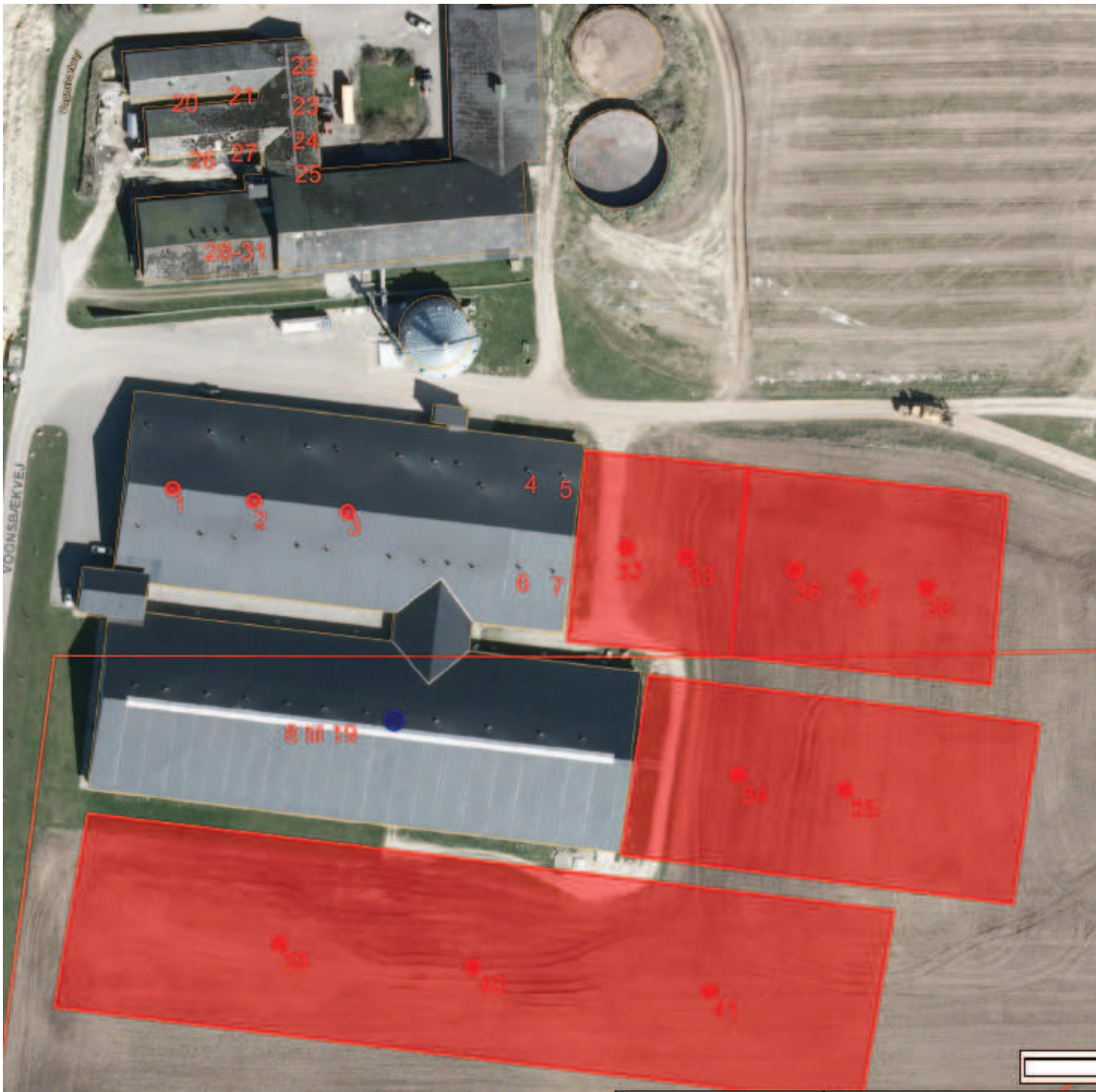
Figur 2 placering af ventilationsafkast. Afkastene 8-19 er ikke indtegnet specifikt, men er placeret på linje i tagryggen, som det ses af luftfotoet. Afkast 34 og 35 udgår, da dette staldafsnit er udgået af godkendelsen.
