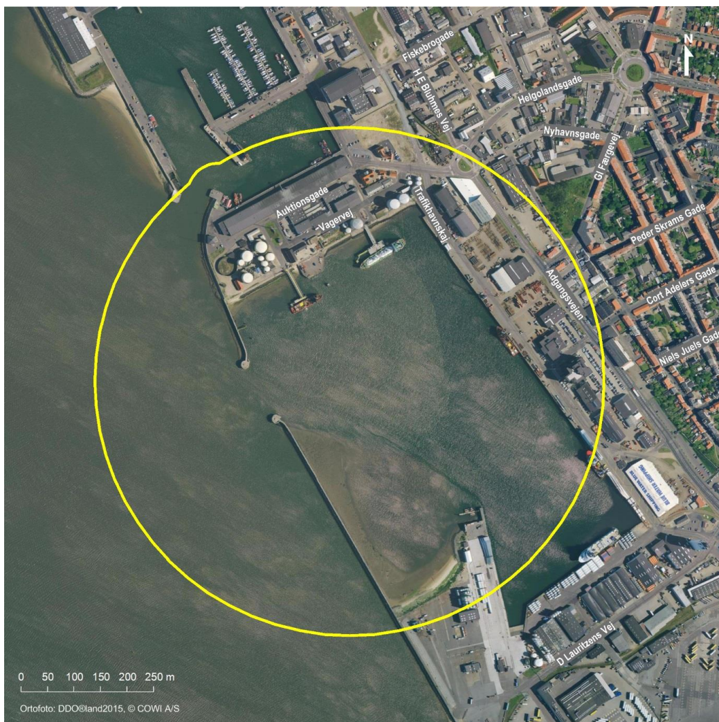
Fig. 1: Maksimal konsekvensafstand fremkommer ved en varmestråling på 4,7 \text{ kW/m}^2 (gul kurve).
