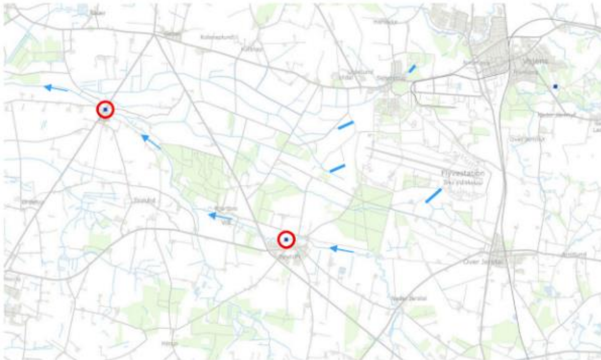
Figur 9 – Målestationer i Gels Å (vist med rød cirkel, strømningens retning (vist med blå pile) og vandløbsstrækninger ved udledninger fra flyvestationen (vist med blå streger)
