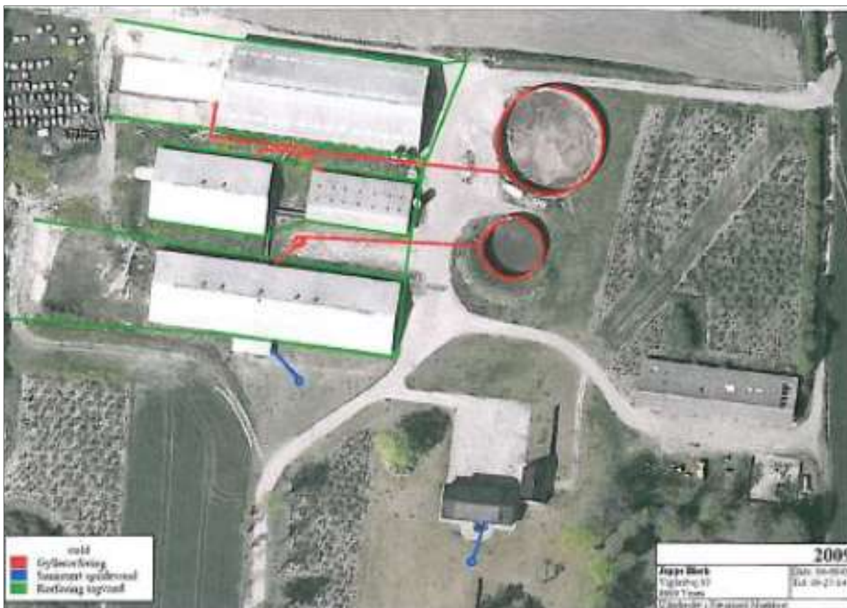
Figur 3. Spildevandsplan til eksisterende anlæg.
