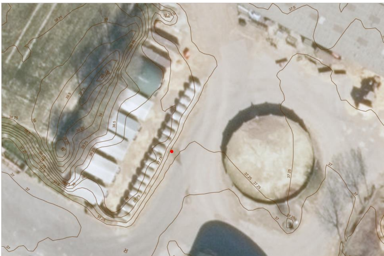
Figur 5-8: Terrænhældning i området omkring kalvehytterne. Rød prik viser afløbet.
