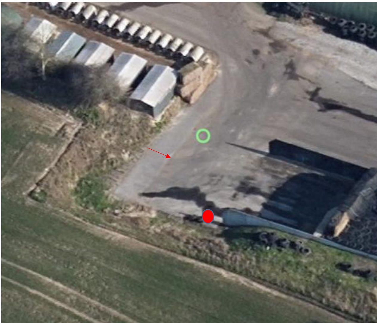
Figur 3-5: hældning i bunden af ensilagepladsen, afløb er placeret ved rød prik og grøn ring.
