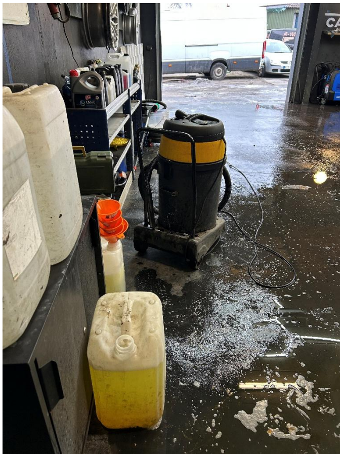
Foto: Vaskeplads spildevand løber ud ad porten til regnvandsafløb
