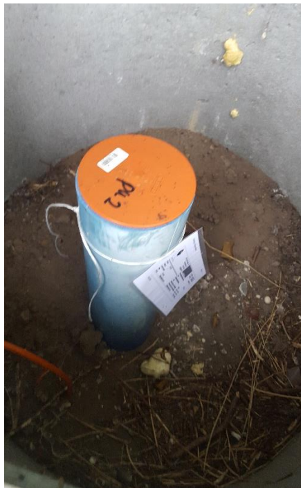
Billede 5 Alle opstrøms boringer havde betonring til beskyttelse mod påkørsel, og aflåst låge. Boringerne er også mærket med vandtæt mærke, hvor DGU nummer er angivet.
