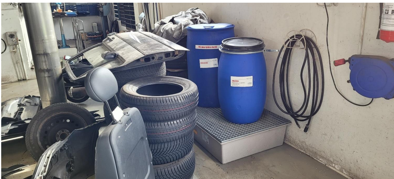
Farligt affald står på spildbakker på værkstedet.
