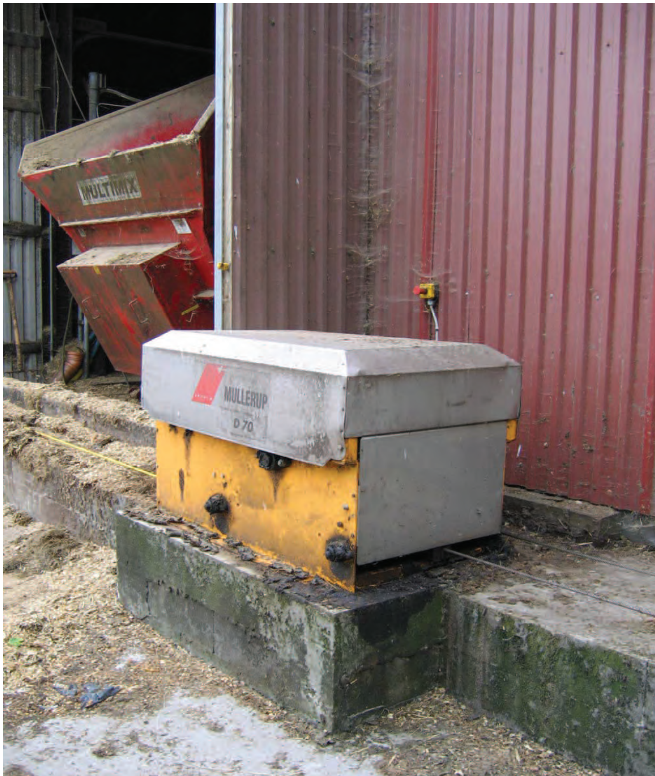
Billede 1. Trækstation med wiretræk placeret udendørs.
