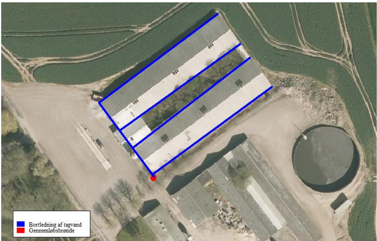
Bortledning af tagvand. Kort med afløb til tagvand. Tagvand ledes til samlebrønd og videre til markdræn. Udløbspunkt kendes ikke.
