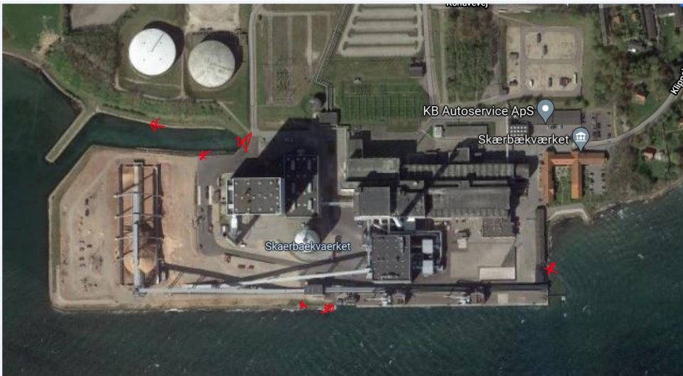
Figur 3.4 Udledningspunkter for almindelig belastet overfladevand.
