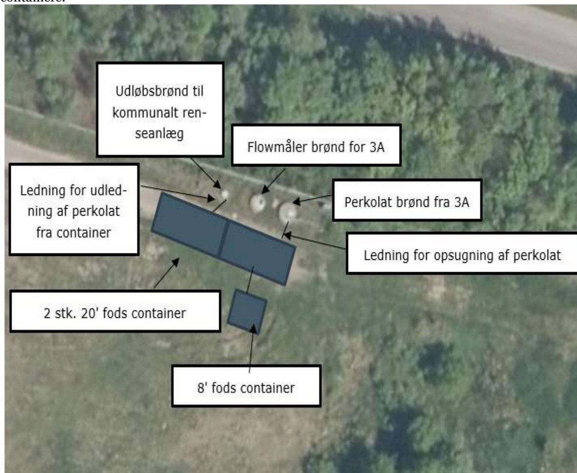
Figur: Skitse for placering af for-rensningsanlægget. Det er ca. placeringer for ledninger og containere.
