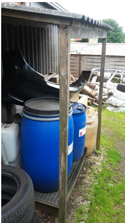
Figur 1. Opbevaring af olieholdigt metalskrot sker på opsamlingsbakke
