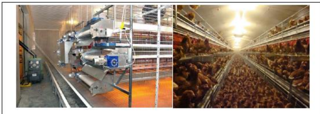
Figur. Billedet til venstre viser gødningsbåndene som afleverer den faste gødning ved enden af systemet i en tvær-kanal/transportbånd. Til højre ses anlægget med høns. Billedet fra billed databasen, Videncenter for Landbrug, Fjerkræ.
