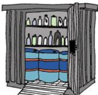
Figur 2 Udendørs opbevaring i container med dobbelt bund.
