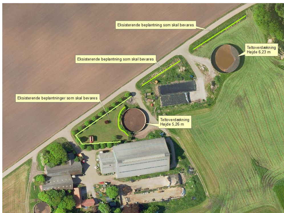
Figur 1. Situationsplan med beliggenhed af de to gylletanke som teltoverdækkes og eksisterende beplantning, som skal bevares.
