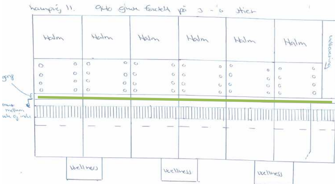
Figur 1. Indretning af slagtesvinestalden med indtegning af gangarealer. Der er en mur imellem ude- og indeareal, som også fragår i produktionsarealet.
