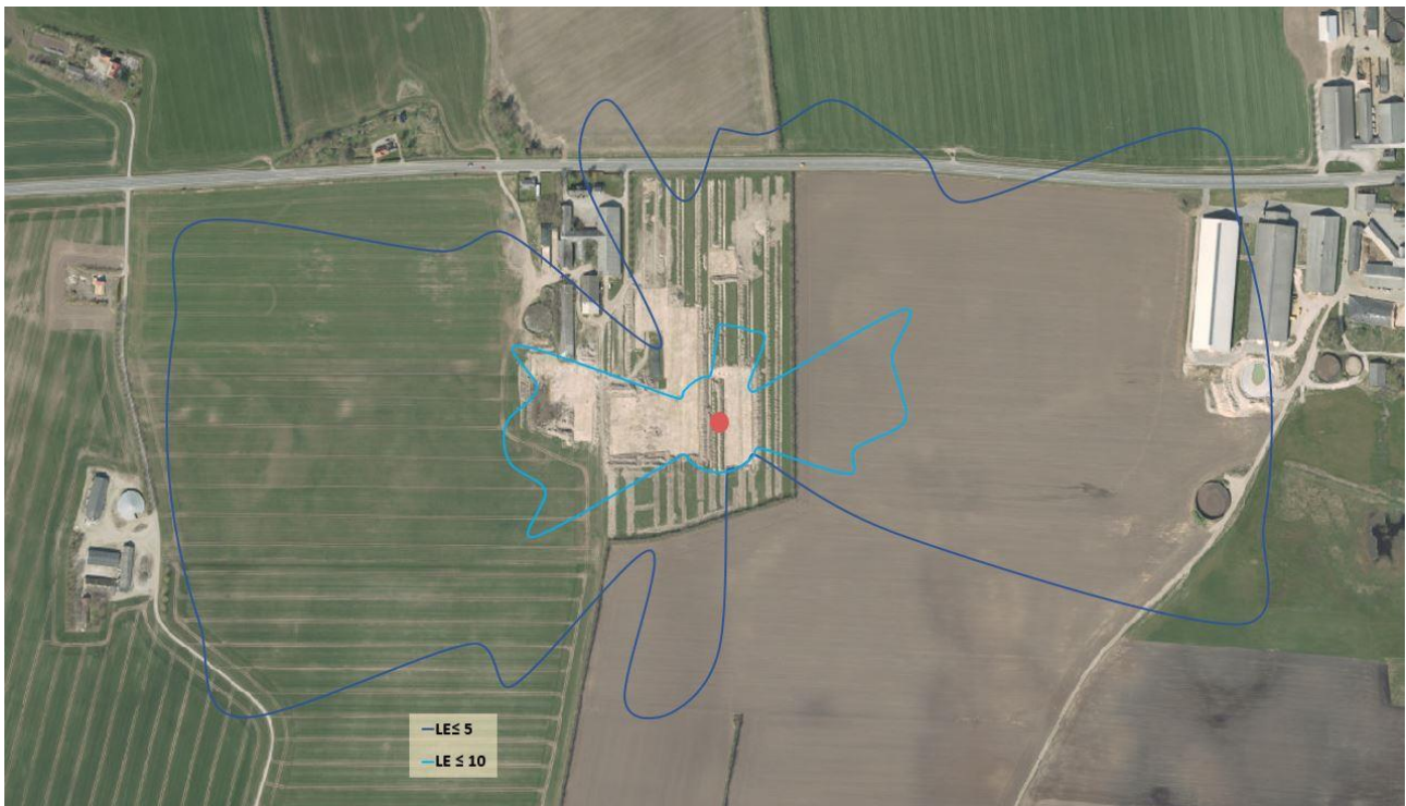
Figur 1: Grafisk repræsentation af lugtpåvirkningen efter ønskede ændring, i henhold til lugtkrav fra Miljøstyrelsen lugtvejledning. Den mørkeblå graf repræsenterer afstanden fra Vesthimmerland Biogas, hvorved lugtkoncentrationen er mindre end eller lig med 5 \text{ LE/m}^3 . Den lyseblå graf repræsenterer afstanden, hvorved lugtkoncentrationen er mindre end eller lig med 10 \text{ LE/m}^3 . Det ses at lugtkoncentrationen på 5 \text{ LE/m}^3 ikke berører nærmeste naboer (beboelse) omkring biogasanlægget.
