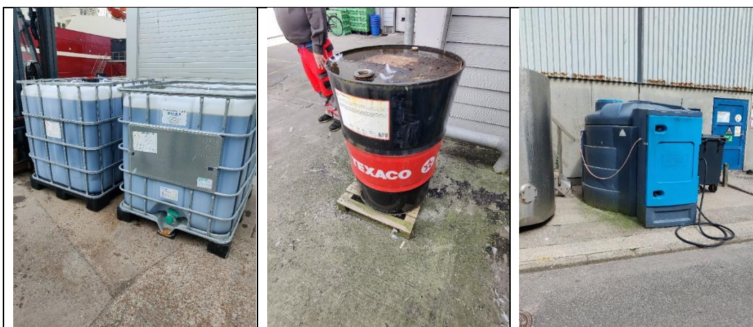
Figur 3 Venstre foto: Palletanke med rengøringsmidler. Højre foto: Tønde med olie placeret uden sikring mod påkørsel og uden spildbakke.
