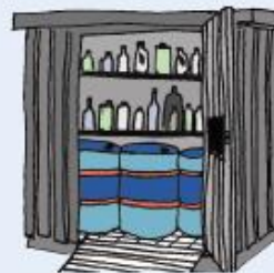
Figur 2: Udendørs opbevaring i container med dobbelt bund.
