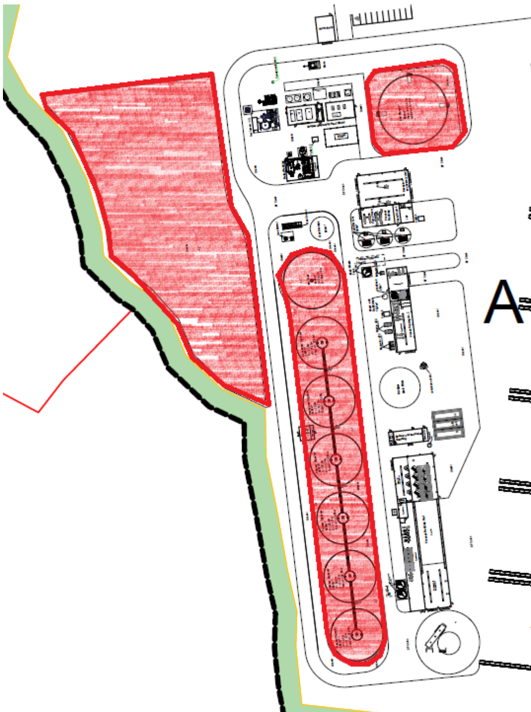
Figur 7: Områder omkranset af jordvold til opsamling af spild i tilfælde af brud på beholder.
