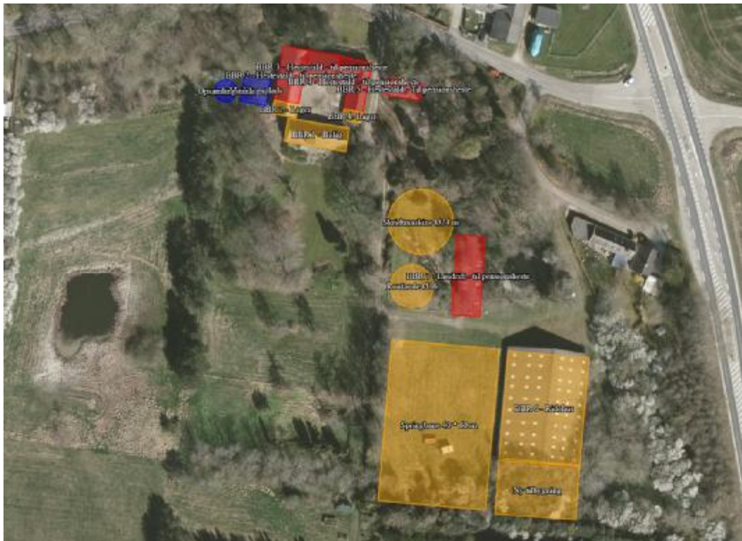
Figur 1. Husdyrbrugets eksisterende bygninger og ansøgte anlæg: staldanlæg (rød), gødningsopbevaringsanlæg (blå) og øvrige faciliteter: ridehus, ridebane, roudonde og skridtmaskine mv. (gul).
