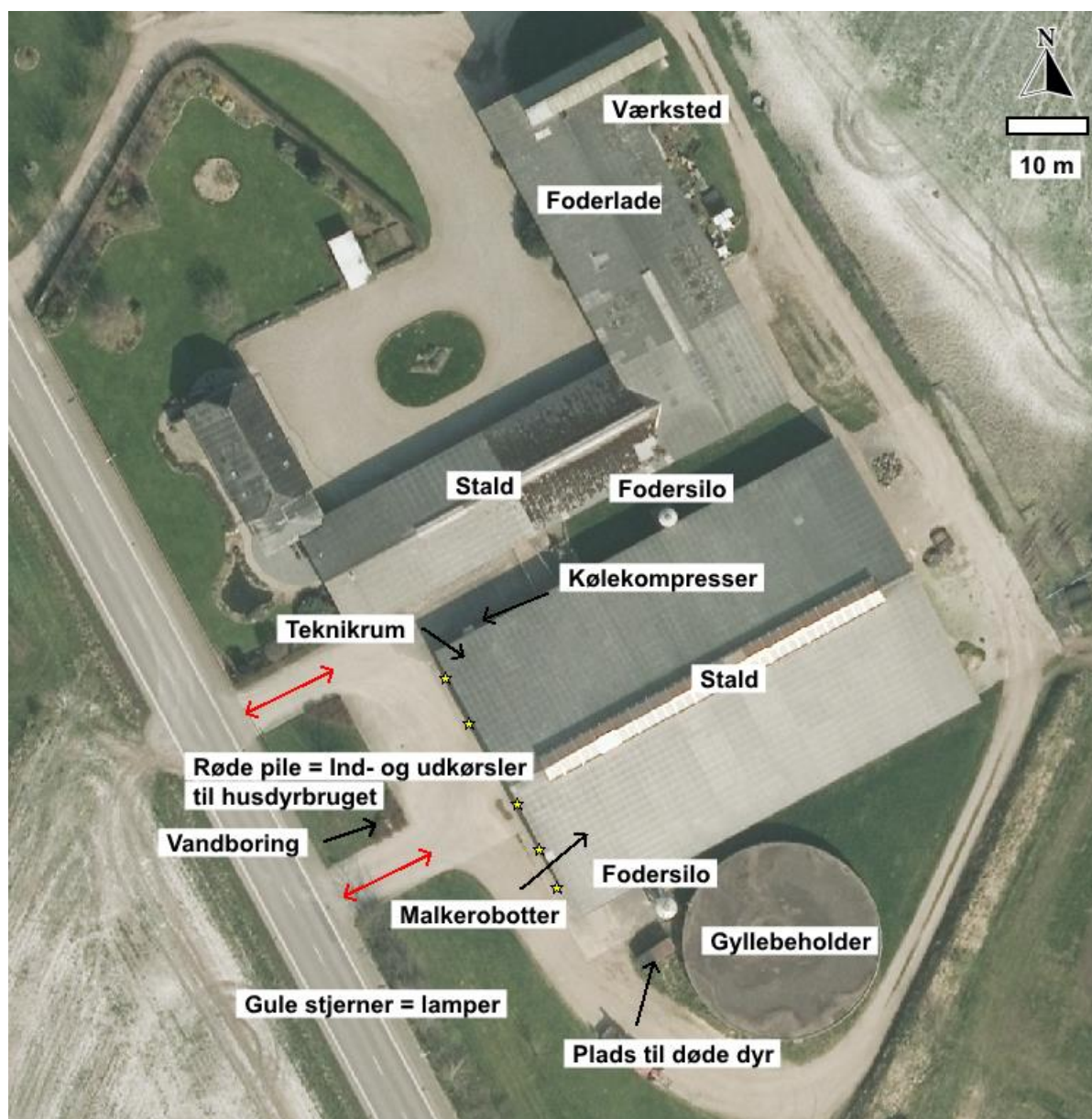
Figur 7: Støjkilder (og udvendig belysning)
