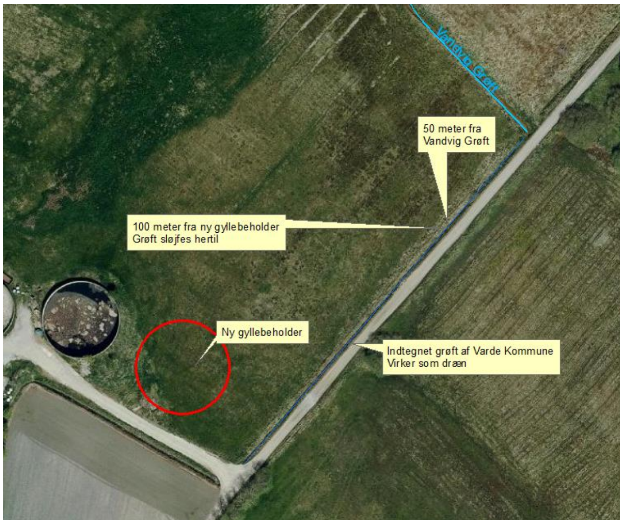
Figur 5. Sløjfning af den eksisterende grøft på vestsiden af grusvejen mod nord, i en afstand af mindst 100 meter fra den ny gyllebeholder stilles som vilkår.
